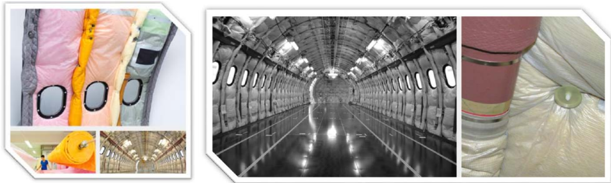
Figure: Matériaux Thermo-Acoustiques utilisés dans les avions.
